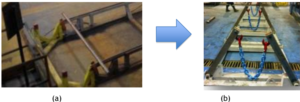
Figura 4: Berço de amarração de maços de barras (a) antes e (b) depois das mudanças
